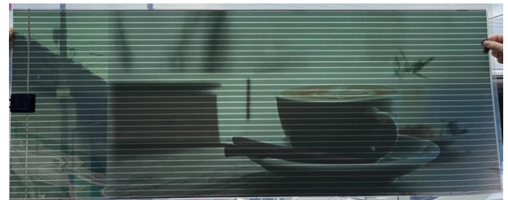
OPV表面への印刷によるデザイン付与
