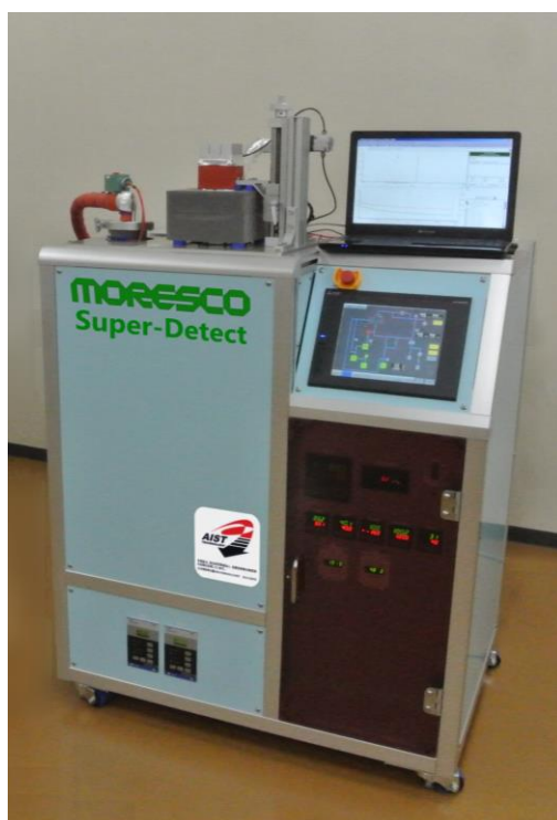
図1 開発したガス・水蒸気透過率測定装置
